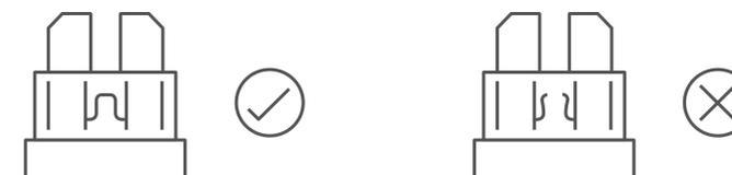
SI LA CONEXION DE LAS PINZAS FUE INCORRECTA Y DEJO DANDO CARGA, EL EQUIPO SE PONDRA EN CORTO Y ETAPA SIGUIENTE PROCEDERA A IR QUEMANDO DESDE LOS CABLES, HASTA EL BOBINADO. SI INTENTÓ DAR ARRANQUE MAS DE 10 SEG. QUEMARA LAS CONEXIONES
